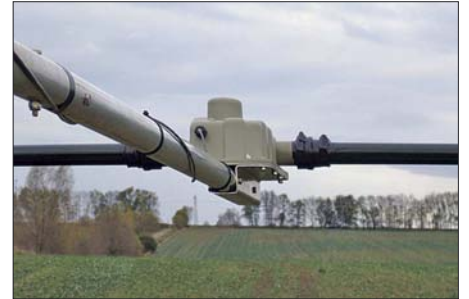
Bild 10: Steuerkabel um den Boom, ...
