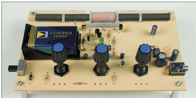
Bild 1: Ansicht der Musterplatte des Einkreisers; die Potenziometer werden direkt in der Leiterplatte verschraubt.
