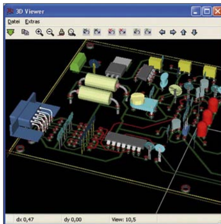
Bild 11: Bauteilkollisionen sind in der 3D-Ansicht der bestückten Platine schnell erkennbar, zumal sich Dreh- und Kippwinkel beliebig einstellen lassen. Screenshots: OE1RIB
