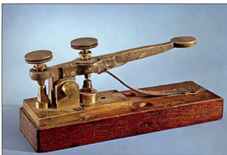
Die von A. Vail gebaute Morsetaste (1844)
