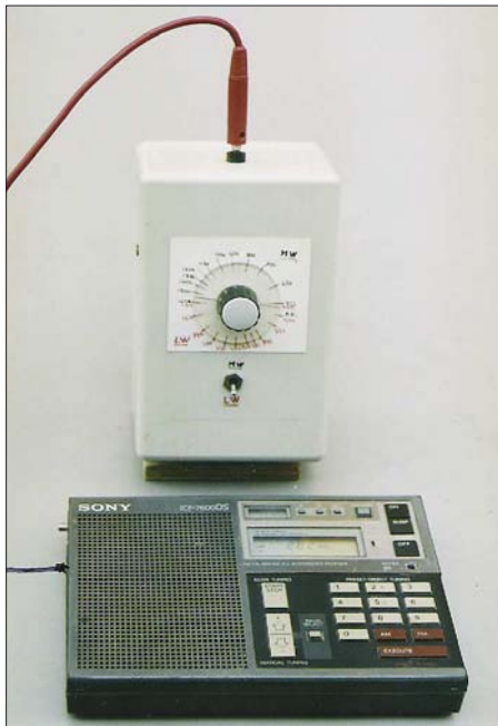
Bild 1: Anordnung des Fuchskreises zum Empfänger; durch Verändern des Abstands lässt sich die Kopplung leicht anpassen. Der Holzkeil unter dem Fuchskreis ist entbehrlich.
