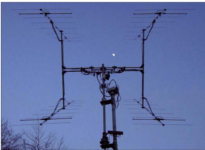
Meist zum Mond ausgerichtet: die Gruppe von vier Achtelement-Yagis bei Steffen, DD0VF
