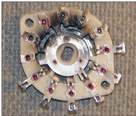
Bild 1: Ein durch Lichtbogenbildung verbrannter Bandwahlschalter – der Lichtbogen entsteht zwischen der Rotationsebene und den Schaltungen für die höheren Bänder, wenn man die PA z. B. auf 80 m oder 160 m abstimmt.
