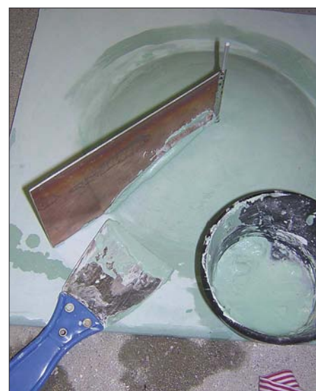
Bild 14: Herstellung der Gipsform für den Parabolspiegel
